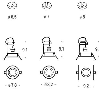
Incassati in tornitura di alluminio, finitura naturale. Ottica orientabile o fissa a seconda della versione. Completo di portalampe, cavo e morsettiera. GX 5.3.
