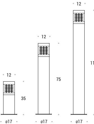
Apparecchi per illuminazione di esterni in estruzione di alluminio. Riflettore in termoplastico trasparente.
