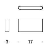
Apparecchio da parete a luce diretta e indiretta, corpo in alluminio verniciato bianco e schermo in policarbonato. Sorgenti luminose led ad alta efficienza 6x2W, tonalità calda. Diffusione in entrambe le direzioni di 90°.
