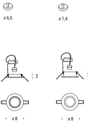
Apparecchio da incasso a soffitto in alluminio. Gamma completa con versioni fisse e orientabili.
