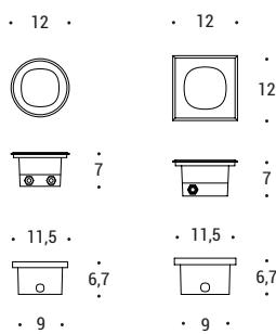
Incasso calpestabile in pressofusione di alluminio con ghiera in acciaio.
