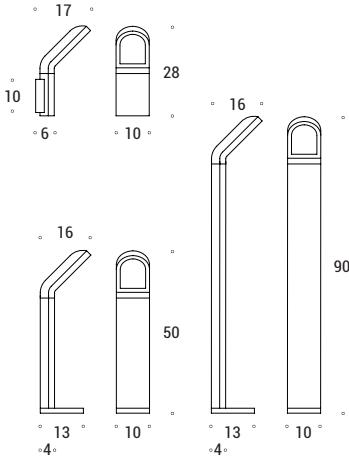
Bollard da esterno a luce diretta, corpo in alluminio verniciato grigio, con vetro frontale di sicurezza. Sorgente luminosa led ad alta efficienza SMD da 9W, tonalità calda, completa di driver e fascio di apertura del flusso luminoso di 100°.
