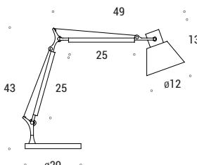
Lampada da tavolo in metallo con braccio orientabile. Diffusore in termoplastico colorato e riflettore interno in alluminio.
