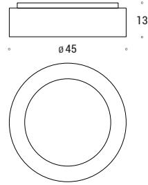
Serie di plafoniere a led in alluminio verniciato con schermo in PMMA. Effetto di luce morbida per l'illuminazione diffusa dell'ambiente.
