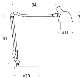
Lampada da tavolo con struttura in materiale termoplastico laccato. Il riflettore è in termoplastico trasparente. La base è realizzata in alluminio colorazione naturale. Completamente orientabile ed estensibile. Interruttore sul riflettore.
