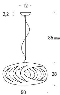
Lampada a sospensione a luce diffusa, con struttura in PU (poliuretano), per lampada con attacco E27 max 60W. Dimensioni 550x360x230 mm. Cavetto di sospensione in acciaio.
