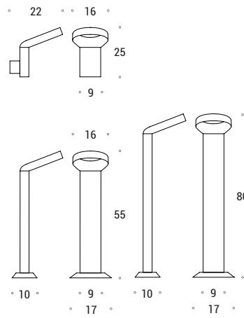
Lampada da terra/parete per esterno in estrusione di alluminio e diffusore in materiale termoplastico opalino.
