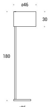
Piantane con stelo in legno per lampada E27. Paralume regolabile in altezza. Per l'illuminazione d'ambiente. Paralumi in tessuto per effetto di luce diffusa o in ecopelle per effetto di luce schermata.
