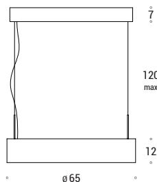
Lampada a sospensione circolare in metallo e schermo in materiale plastico in colore opale. Sorgente luminosa led ad alta efficienza da 47W, tonalità calda, completa di driver. Flusso luminoso diretto e diffuso.
