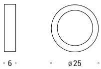
Lampada da soffitto in gesso con diffusore in policarbonato. Sorgente luminosa a led ad alta efficienza da 15W, driver incluso.
