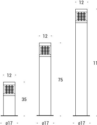
Apparecchi per illuminazione di esterni in estrusione di alluminio. Riflettore in termoplastico trasparente.
