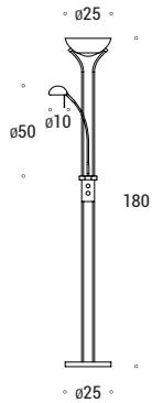
Lampada da terra in metallo con doppia funzionalità. Dimmer sulla struttura. Diffusore principale in metallo con vetro satinato centrale per illuminazione indiretta. Braccio con posizione regolabile per luce lettura. Cavo di alimentazione in termoplastico trasparente.
