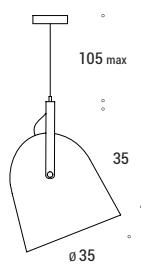
Sospensione in metallo verniciato. Fornito di staffa che permette al riflettore di orientarsi. Per lampada E27 led, fluorescente o alogena.
