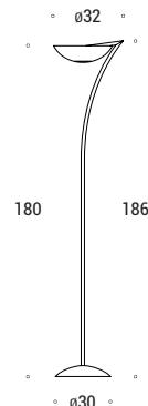
Lampada da terra in metallo. Diffusore in vetro satinato. Cavo di alimentazione in termoplastico trasparente ed interruttore a pedale on/off.
