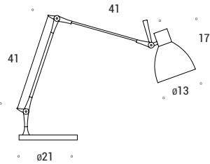
Lampada da tavolo in metallo con riflettore interno in alluminio ed esterno in termoplastico. Braccio e riflettore orientabili. Interruttore sul cavo di alimentazione.
