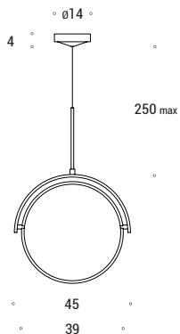
Sospensione a led. Corpo in metallo verniciato, schermo diffondente in PMMA orientabile. Effetto di luce morbida e diffusa per l'illuminazione d'ambiente.
