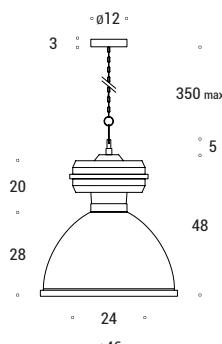
Sospensione in stile "industrial". Corpo in alluminio verniciato e schermo in PMMA trasparente. Installabile a sospensione con catena in dotazione. Equipaggiata con lampada tipo led filament intercambiabile su attacco E27. Per l'illuminazione diretta del tavolo o del piano di lavoro.
