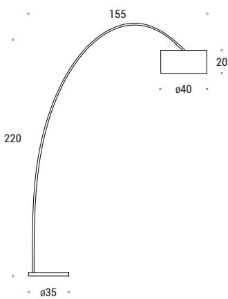
Lampada da terra con struttura in metallo. Paralume in tessuto. Cavo di alimentazione trasparente con interruttore on/off a pedale.
