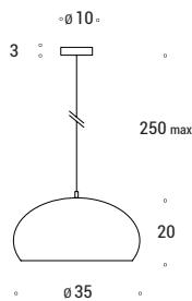
Sospensione a led per illuminazione diretta. Corpo in alluminio verniciato e schermo diffondente in PMMA. Effetto di accento a luce morbida e uniforme.
