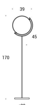
Piantana a led. Corpo in metallo verniciato, schermo diffondente in PMMA orientabile. Completa di foot dimmer. Effetto di luce morbida e diffusa per l'illuminazione d'ambiente.
