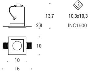
Incassati in gesso con corpo lampada a scomparsa totale. Ideali per installazione in pareti/soffitti in cartongesso. Ottica fissa.
