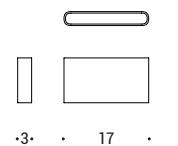
Apparecchio da parete a luce diretta e indiretta, corpo in alluminio verniciato bianco e schermo in policarbonato. Sorgenti luminose led ad alta efficienza 6x2W, tonalità calda. Diffusione in entrambe le direzioni di 90°.
