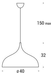
Sospensione a luce diretta con struttura in alluminio laccato bianco. Sorgente luminosa led ad alta efficienza da 30W, tonalità calda, dimmerabile. Cavetto di sospensione in acciaio. Regolabile per potenza e per temperatura di colore da 2000K a 3000K. La variazione in gradi Kelvin, ottenibile con un regolatore 0...10V, permette di accompagnare le ore del giorno e della notte con la temperatura di colore più adatta alle attività svolte, stimolandone positivamente i ritmi naturali.
