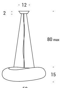
Sospensione in PMMA (polimetilmethacrilato) cavo di altezza regolabile. Rosone a soffitto in metallo bianco.
